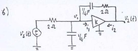
$$\begin{bmatrix} i_1 \\ v_2 \end{bmatrix} = \begin{bmatrix} 0 & 0 \\ K & 0 \end{bmatrix} \begin{bmatrix} v_1 \\ i_2 \end{bmatrix}$$
