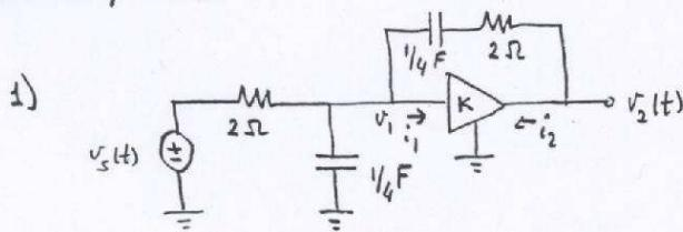
$$\begin{bmatrix} i_1 \\ v_2 \end{bmatrix} = \begin{bmatrix} 0 & 0 \\ K & 0 \end{bmatrix} \begin{bmatrix} v_1 \\ i_2 \end{bmatrix}$$
