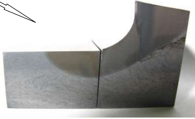
Şekil 4. R numunesinde, aks şaftının köküne uygulanan indüksiyon ile sertleştirme. Çatlak ile indüksiyonla sertleştirilmiş tabakanın ilişkisi de ok ile işaretlenmiştir.
